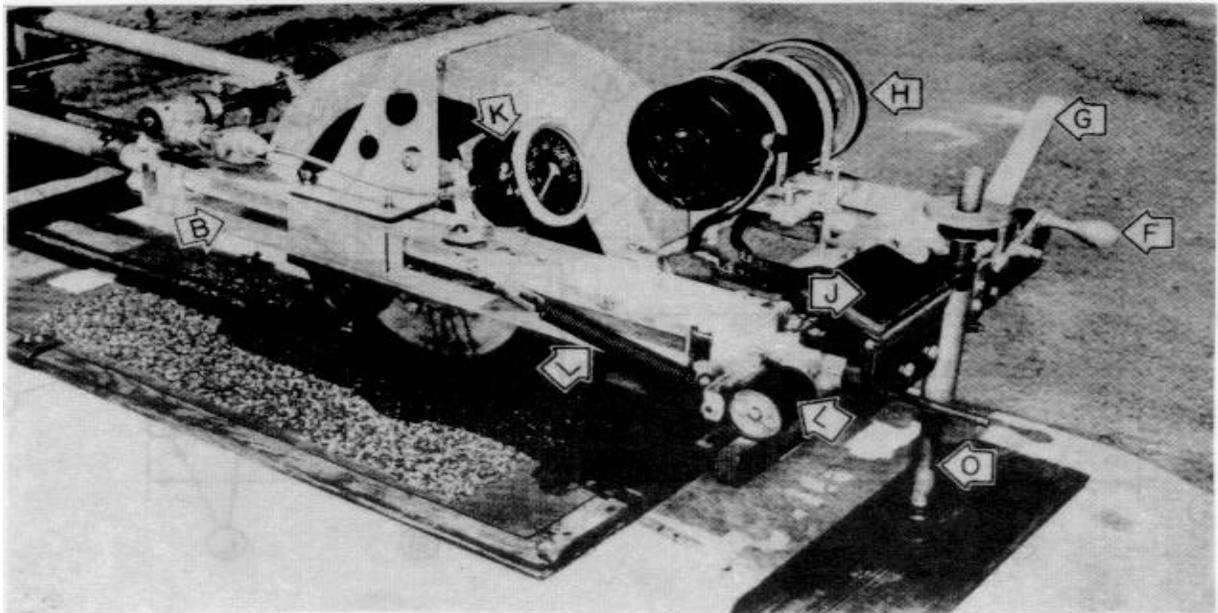
FIGURE 2 - SIDE VIEW OF SKID TESTER
